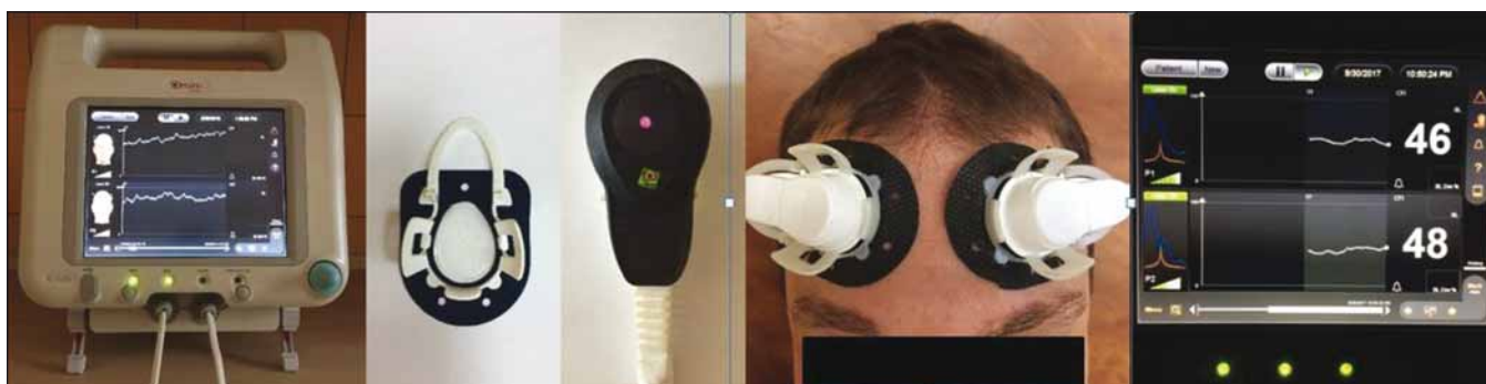
Obr. 2. Zariadenie C-FLOW, snímače cerebrálneho prietoku krvi, ich umiestnenie a grafické zobrazenie indexu cerebrálneho prietoku krvi. Fig. 2. C-FLOW device, blood flow sensors, their placement and a display of the cerebral flow index.
