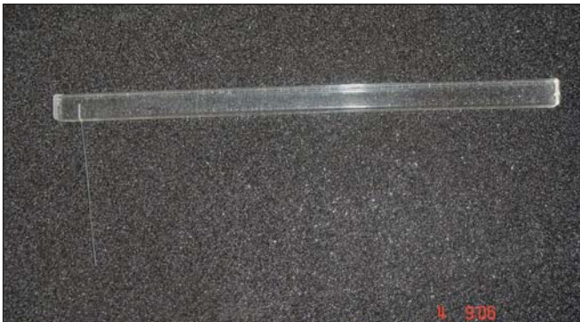
Obr. 2a) Semmes-Weinsteinovo filamentum, vyrobené z nylonu (fy. Somedic).
