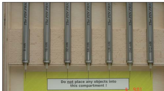
Obr. 3b) Sada kalibrovaných špendlíků.
