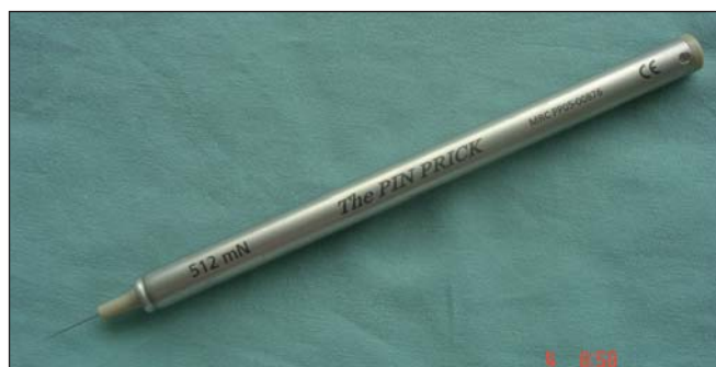
Obr. 3d) Kalibrovaný špendlík.
