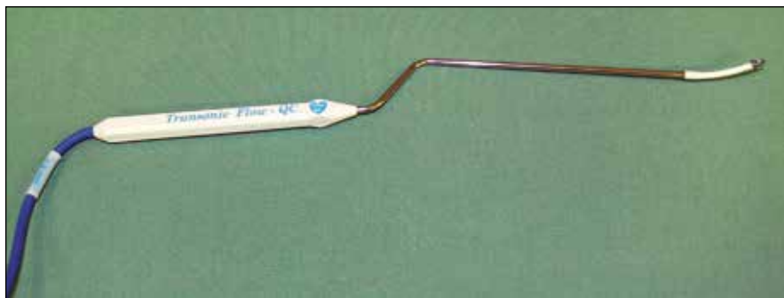
Obr. 2. Perivaskulární bajonetovitá mikrosonda.
