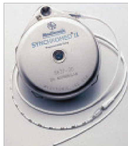
Obr. 1. Implantabilní léková pumpa Synchroned II.
