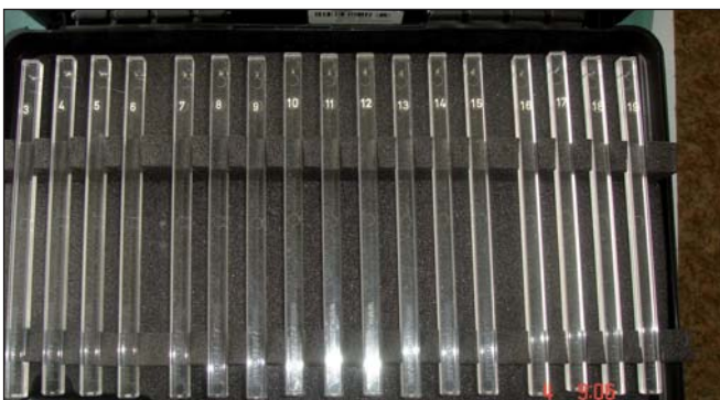
Obr. 2c) Sada kalibrovaných filament, vyrobených z nylonu (fy. Somedic).
