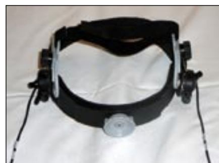
Obr. 5. Ultrazvukové sondy s fixačním zařízením.
